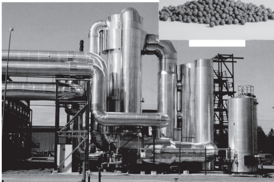
CATOX jedinica za pročišćavanje 55.000 Nm 3 /h otpadnog zraka
